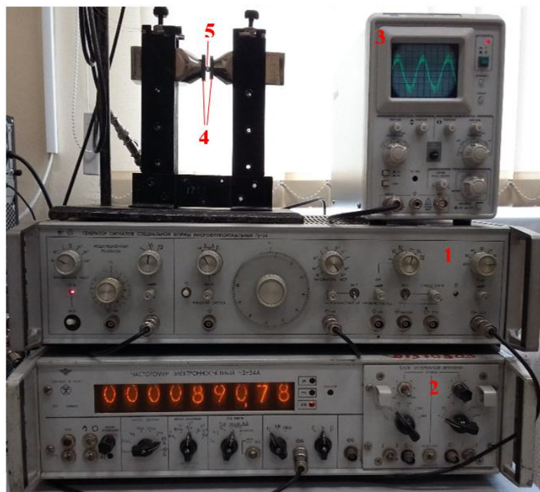
Рис. 8 – 1 – генератор сигналов специальной формы многофункциональный «Г6-34», 2 – частотомер электронносчетный «ЧЗ-34», 3 – осциллограф «GOS-310», 4 – постоянные магниты, 5 – образец монокристалла алюминия, помещенный в катушки
